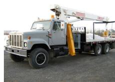
Prenez note que la distance maximale entre le dernier essieu et l'extrémité arrière des camions-flèches (boom trucks) assemblés avant novembre 1998 est maintenue à 5 mètres, et ce, jusqu'au 31 décembre 2014. Nous vous rappelons que ces véhicules doivent être munis d'un permis spécial de classe 1 pour circuler au Québec.
